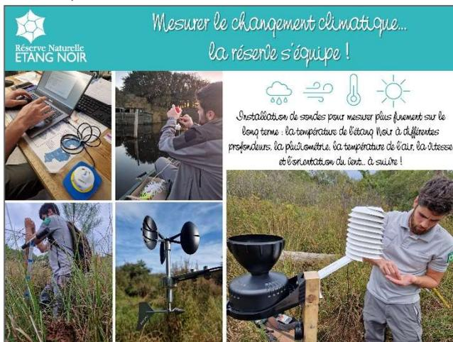
Cette année le matériel a été acquis et installé en octobre 2023 sur la partie ouest du site. Cette sonde (base des mesures climatologiques dans le cadre du programme Natur'Adapt) cumule plusieurs outils de mesure (baromètre, anémomètre, thermo-hygromètre, pluviomètre, pyranomètre). En complément, un lot de sonde aquatique a été acquis et installé (6 sondes) permettant un suivi des
